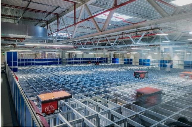
Im automatisierten Kleinteilelager mit AutoStore-Technologie unterstützt ein robotergesteuertes Greifersystem beim Ein- und Ausladen der Ware.
