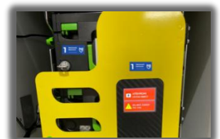
System im starren Pairing-Modus – Kassetten und Smartdoors haben passende Netzwerkaufkleber
